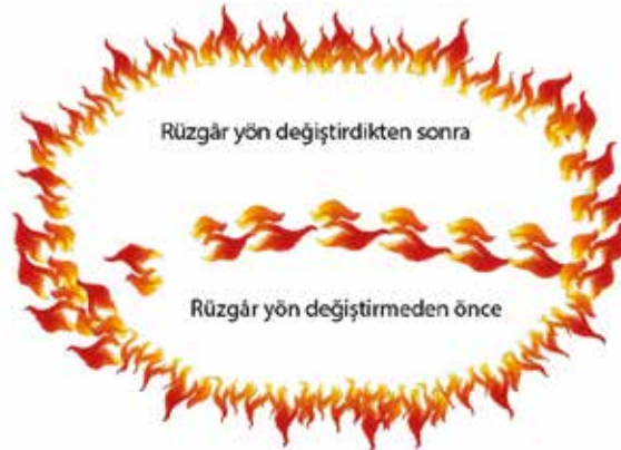
Şekil 4. Yangında rüzgarın yön değiştirmesine göre yangın yönünün değişmesi
