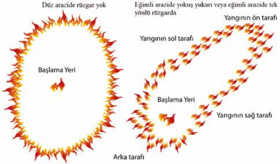
Şekil 3. Rüzgara göre yangın davranış şekilleri
